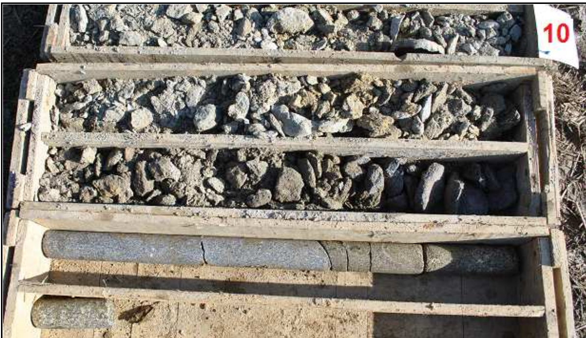
Obr.č. 2 : Přiblížený pohled na spodní část profilu vrtu PJ 1 , zřetelně přibližující geotechnickou kvalitu granodioritového podloží. Zdravé partie jsou pevné, málo rozpukané, navětralé partie středně pevné, středně rozpukané. Od úrovně 12 m byla provedena změna ve vrtné technologii s nasazením DIA hloubení s výplachem. V úrovni 13,2 m bylo hloubení přerušeno z důvodu rozlomení DIA vrtné korunky.
