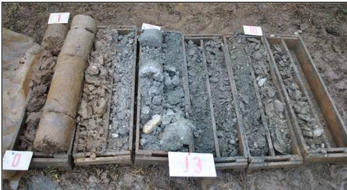
Obr.č. 6 : Pohled na geologický profil vrtu J 3, hluboký 11 m. Kvartérní pokryv dosahuje mocnosti 5,4 m a je tvořen souborem kvartérních naplavenin obdobného vrstevního sledu . Granodioritové podloží je intenzivně rozvětralé do hloubky 6,5 m, hlouběji s přechodem silně zvětralé, od 7,5 m do mírně zvětralé, málo pevné horniny, třídy R4 . Hladina podzemní vody ustálena 3,00 m pod terénem .
