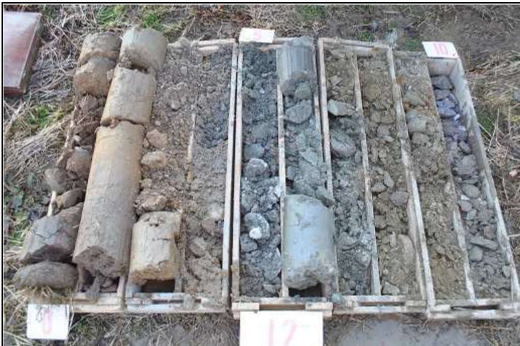
Obr.č. 3 : Pohled na geologický profil vrtu J2, hluboký 10 m.
