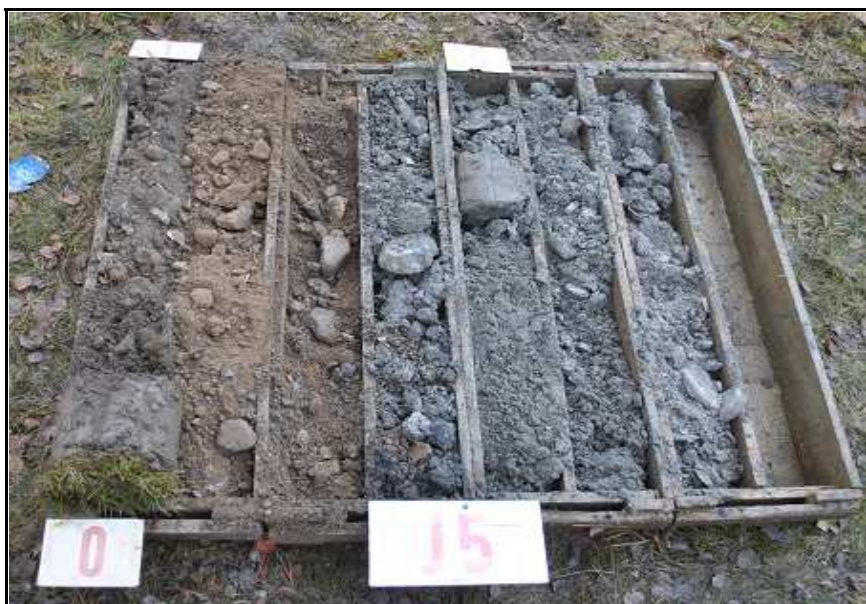
Obr.č. 11 : Pohled na geologický profil vrtu J 5, hlubokého 7 m. Kvartérní pokryv dosahuje mocnosti 4,0 m , od 3 m ve štěrkopísčitém vývoji. Granodioritové podloží je do hloubky 6 m zcela rozvětralé, hlouběji silně zvětralé, od 6,5 m s přechodem do mírně zvětralé horniny R4. Hladina podzemní vody ustálena 3,0 m pod terénem.
