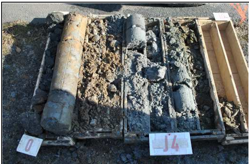
Obr.č. 9 : Pohled na geologický profil vystrojeného vrtu PJ 4, hlubokého 8,2 m. Kvartérní pokryv dosahuje mocnosti 6,2 m a je tvořen souborem kvartérních naplavenin , svrchu v jílo-písčitém , od 2,7 m štěrkopísčitém vývoji. Granodioritové podloží je zcela rozvětralé do hloubky 8 m, hlouběji s přechodem di silně zvětralé horniny, třídy R5. Hladina podzemní vody ustálena 3,40 m pod terénem.
