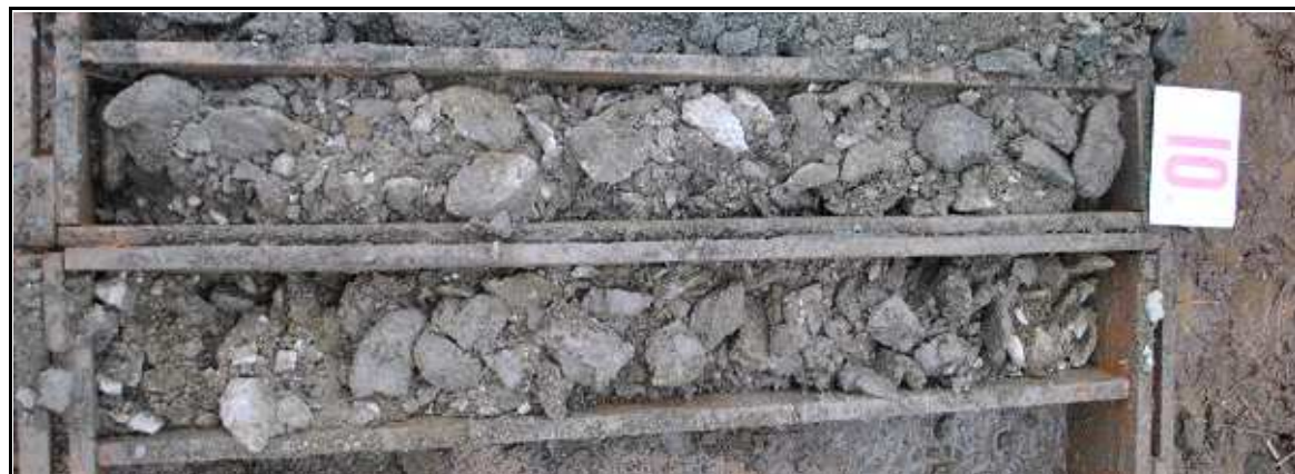
Obr.č. 7 : Přiblížený pohled na spodní část profilu vrtu J3, ukončeného v mírně zvětralém granodioritu.
