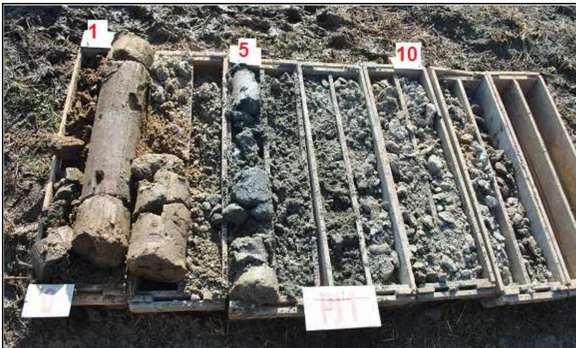
Obr.č. 1 : Pohled do vzorkovnice na geologický profil vystrojeného vrtu PJ1, hlubokého 13,2 m. Kvartérní pokryv dosahuje mocnosti 4,2 m a je tvořen souborem kvartérních naplavenin, svrchu v jílovito-písčitém od 2,4 m ve štěrko-písčitém vývoji. Granodioritové podloží je intenzivně rozvětralé do hloubky 7,7 m, hlouběji s přechodem do silně zvětralé, od 9 m mírně zvětralé horniny, pevnostní třídy R4. V úrovni 11,7 m zaznamenán přechod do zdravých a navětralých skalních partií. Kolektorem kvartérní zvodně je štěrko-písčitý soubor, silné průlinové zvodnění zaznamenáno i v rozvětralých horninových partiích. Hladina ustálena 2,85 m pod terénem.
