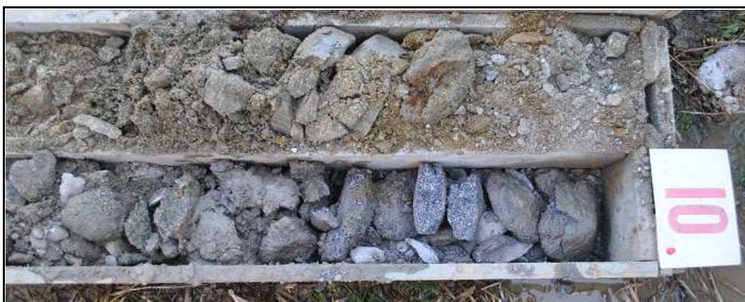
Obr.č. 4 : Přiblížený pohled na spodní část profilu vrtu J2, ukončeného ve zdravém granodioritu.
